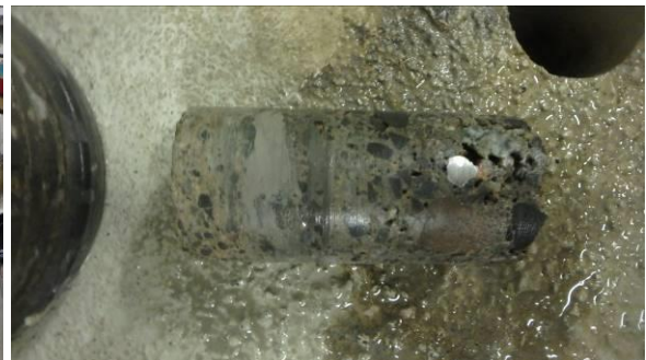
Näyte OL.03 otettiin alueelta, jossa havaittiin öljyhiilivedyt (OL.03) analysoidiin noin 90 mm paksuisesta lieriöstä (pintalaatasta)
