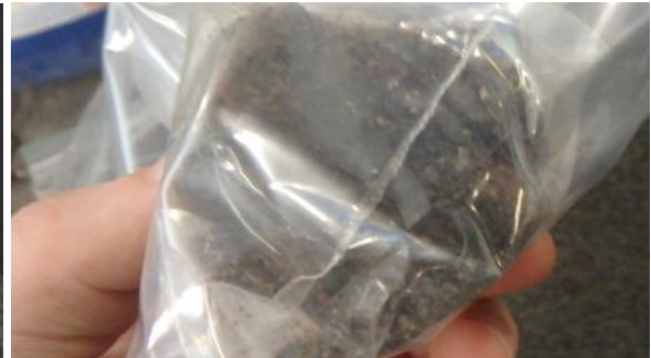
Kivihilipiki (ASB.15) alapohjan kaksoislaatan välissä sisältää asbestia
